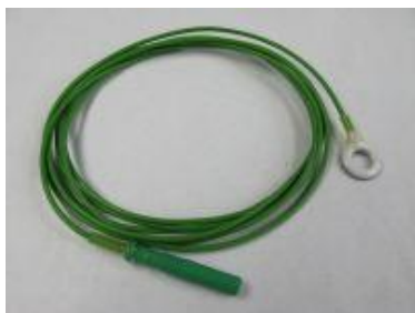
Gesinterte Ag/AgCl-Ringelektrode (auch geeignet für EKG und EMG), 1 Stück
